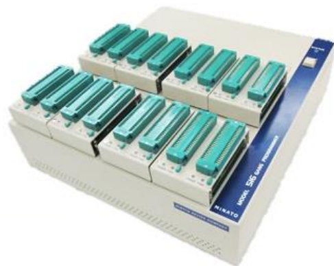
デバイスプログラマ ROMやCPU等のデバイスに データを書込む機器
